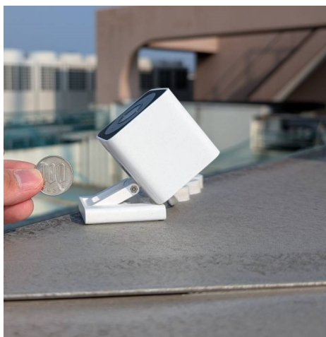
図 2.1: 岡山大学に設置したカメラ。中央の白い立方体がカメラ。カメラの左に写っている硬貨は 100 円玉。
