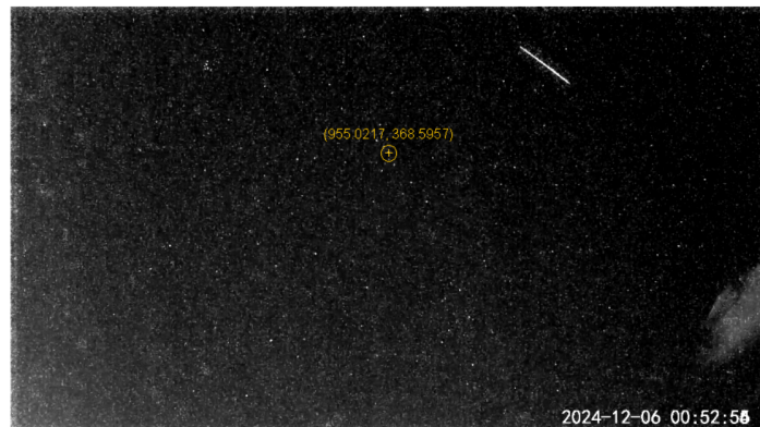
図 2.4: AstroImageJ を用いて恒星の画像上の位置を測定する。画面中央やや上にある丸で囲まれた恒星の画像上の位置を測定したときの画面。
