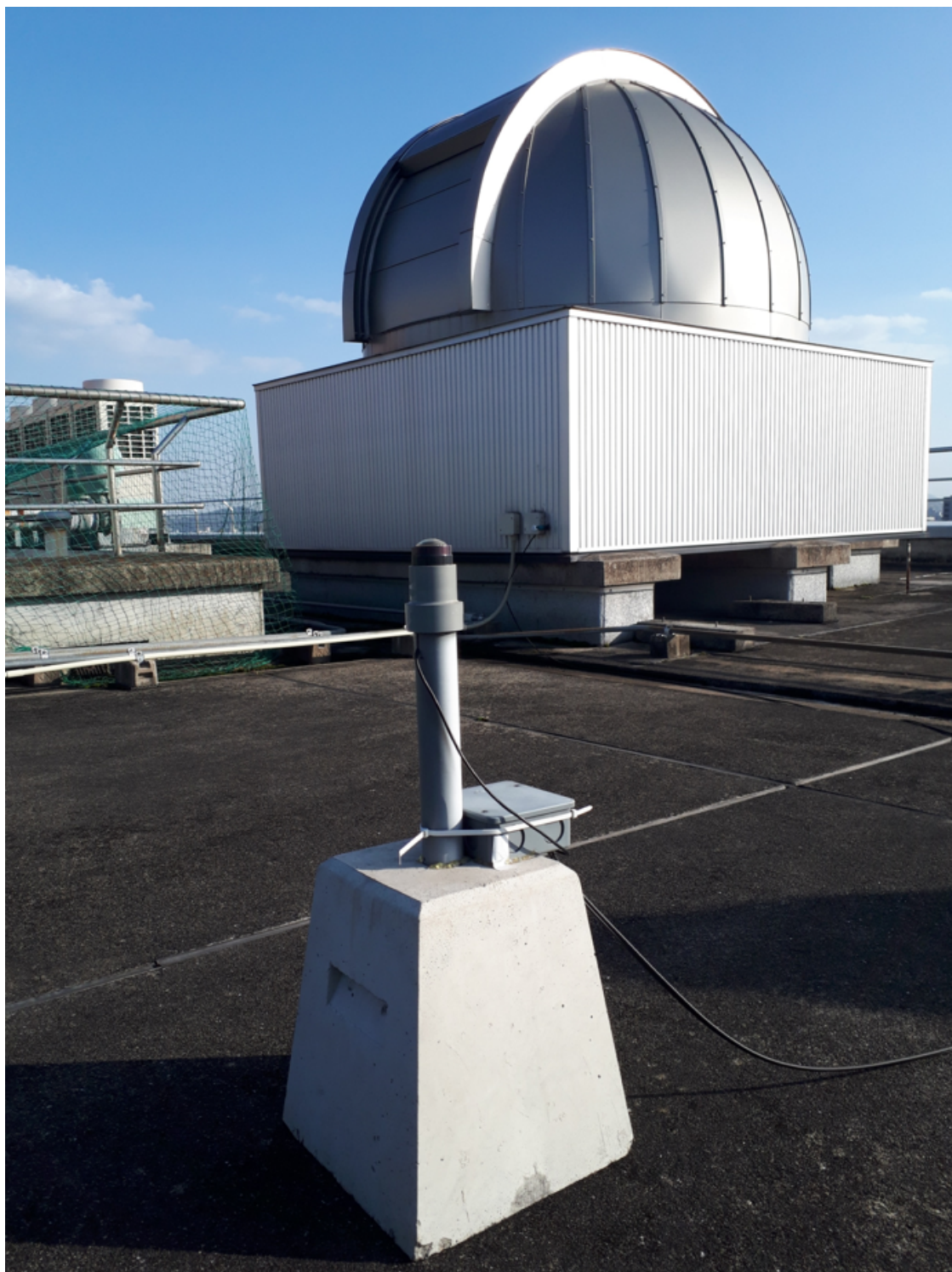
図 2.2: 撮影システム. 旗竿を立てる台に取り付けたカメラ. 後ろに写っている銀色のドームは 岡山大学天文台.
