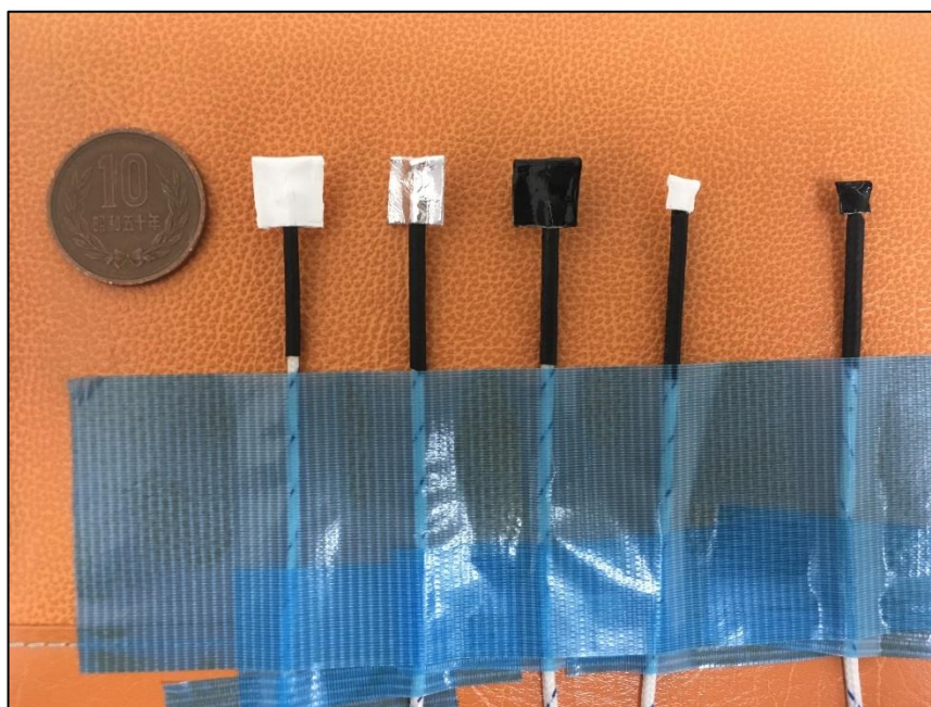
図 11：作成した 3 色温度計
