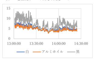
図は3色温度計の示した温度の時間経過である。白とアルミの温度計が示した温度変動に比べ、黒の温度計が示した温度変動の大きいことがわかる。これは、日射の吸収率の違い(白とアルミは小、黒は大)によるものとして説明することができる。岡山大学天文台に設置されたスカイモニターが記録した空の画像と対応させることで、黒の温度計が高い温度を示すときは日射があり、黒の温度計が低い温度を示すときは雲によって日射が遮られていることが確認された。この結果は3色温度計によって日射強度の評価が可能であることを示し、日除けを使わない気温測定は実現可能であることを示している。
