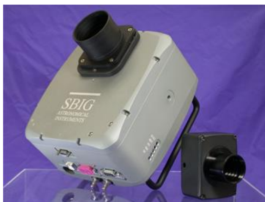
図 2.2 本研究で使用した冷却 CCD カメラ (画像は http://www.sbig-japan.com/STL-1001E.html から引用)
