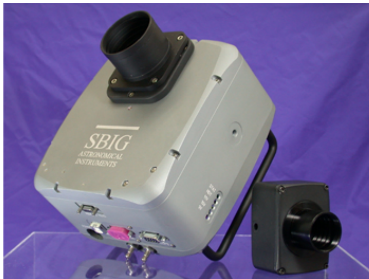
Fig. 2.5 STL-1001E。左が本研究で使用した KAF-1001E・NABG。右がTI社製 TC-237H・ABG
