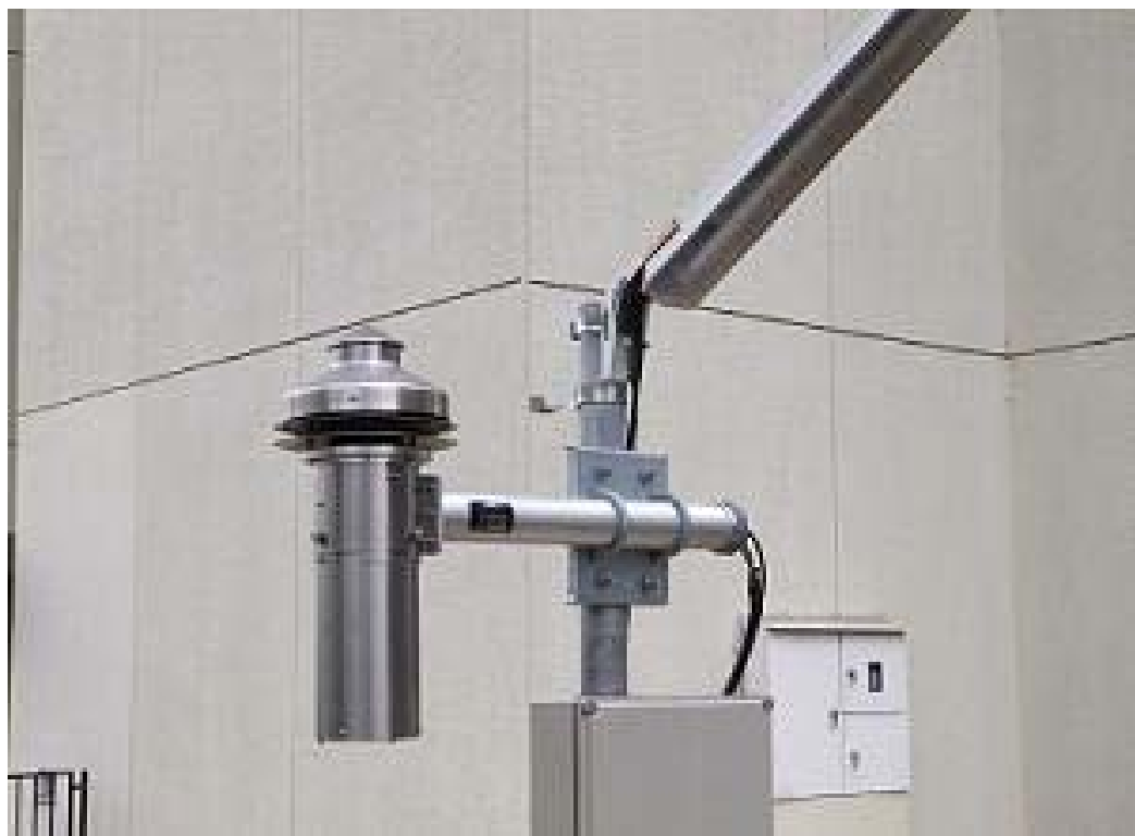
通風筒の外観
