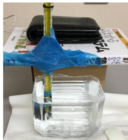
図 2.2：熱電対の較正実験
