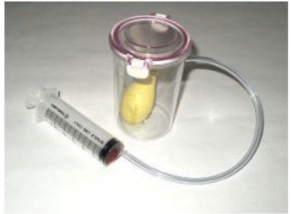
Figure 5. 簡易真空実験装置の全体写真. 写真は山本明利「YPC 簡易真空実験器」から引用.
