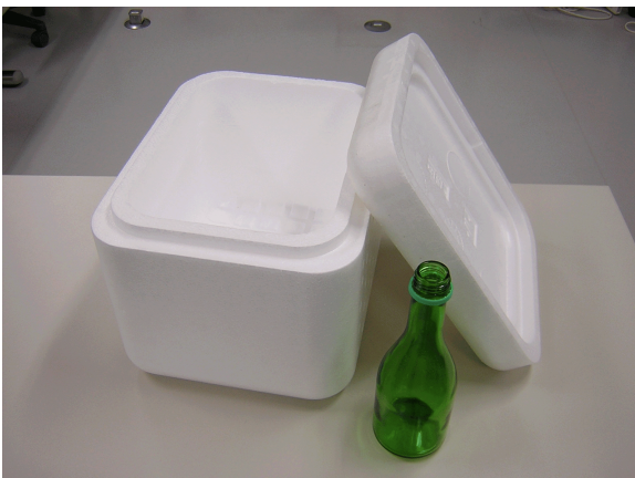
Figure 3. 断熱容器. 発泡スチロール製の断熱容器 (手前にある緑色の瓶の容積は 300ml). 断熱容器はこのような立派なものだけでなく、断熱性能が高いほど気圧計はより正確になる。測定のために装置を持って移動するので、大きいものは不便である。
