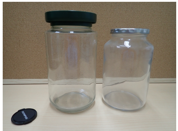
Figure 6. 密封容器. 写真はインスタントコーヒー (左) とパスタソース (右) の瓶. 容器と蓋の接合部にパッキンがついているものがよい. 湿気を嫌うものや液体が入っていたものは、たぶん使える. 蓋は穴あけ加工できるものである必要があるが、柔らかくて簡単に変形するのは不可. 大きいものの方が使いやすい. ガラス瓶は 100 円ショップでも入手可能.
