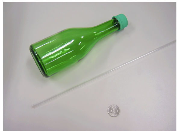
Figure 2. アクリルパイプとガラス瓶. 中央のアクリルパイプの内径は 4mm(外径は 6mm). 左上は日本酒が入っていたガラス瓶 (300ml). ドリンク剤の瓶などもガラス瓶として利用可能. 右下は 100 円硬貨.
