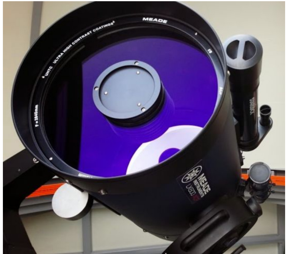
岡山大学理学部望遠鏡 口径356mm反射望遠鏡 焦点距離2845mm(F=8) 反射屈折光学系、赤道儀架台
